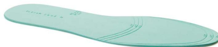
Soporte de plantilla de esponja verde para montaje de elementos correctores ortopédicos. Espesor de 2 mm en puntera y 3 mm en talón. Superficie inferior antideslizante.
